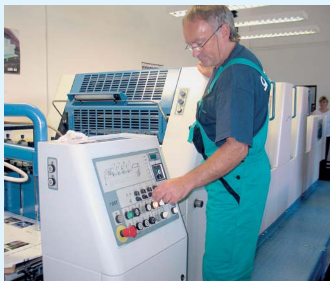
Chloubou Střední školy propagační tvorby a polygrafie je od počátku nového školního roku moderní čtyřbarvový archový ofsetový stroj
